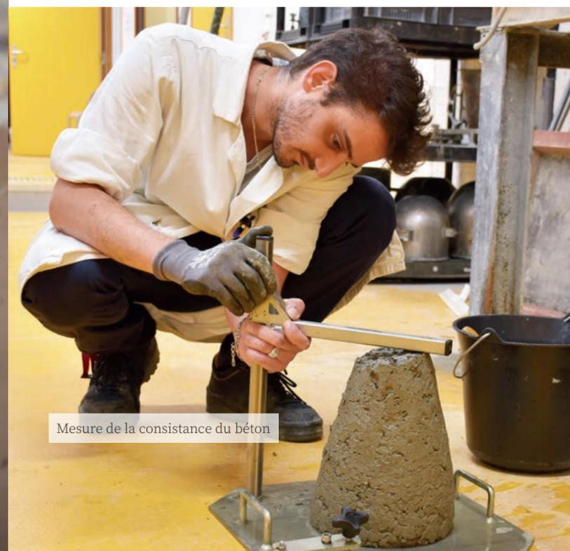
Mesure de la consistance du béton
