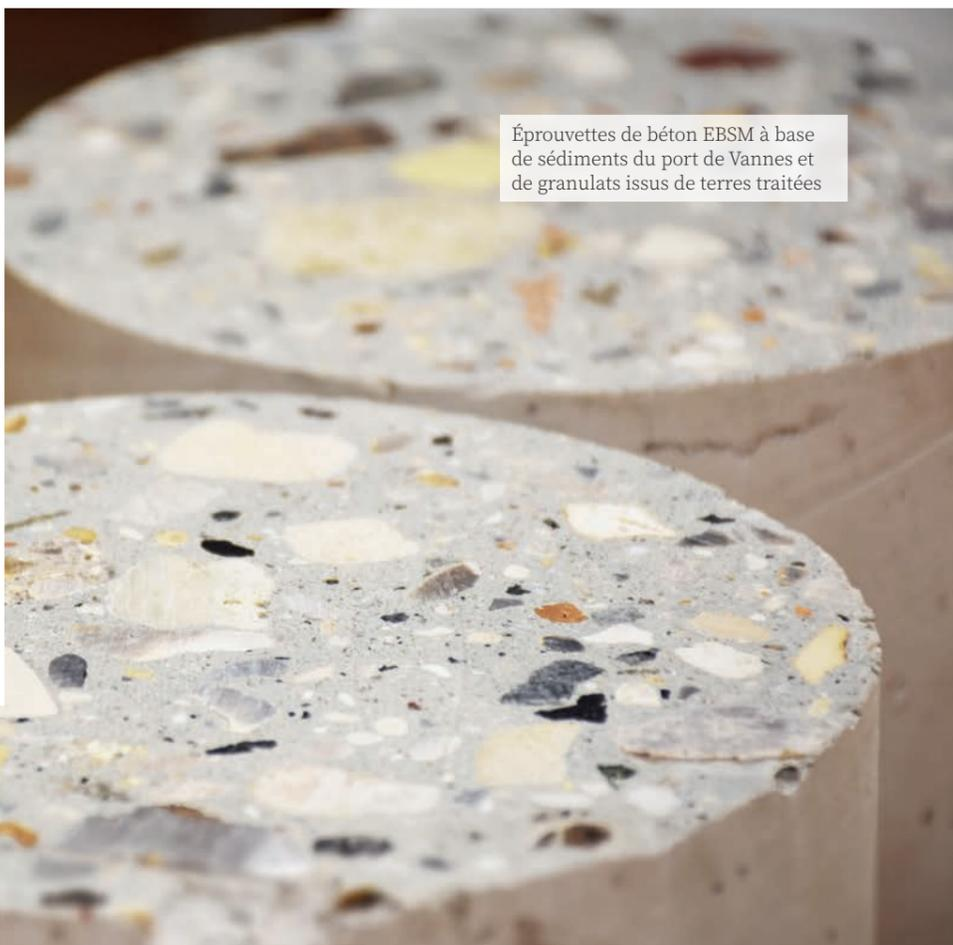
Éprouvettes de béton EBSM à base de sédiments du port de Vannes et de granulats issus de terres traitées
