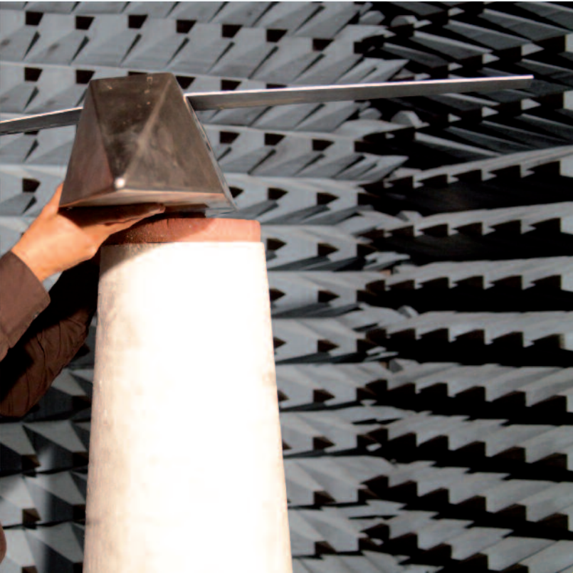
↑ Chambre de mesure de surface équivalente radar de 8 à 40 GHz
